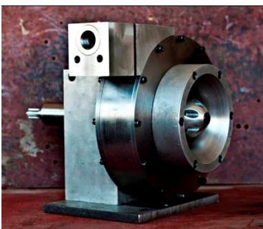
*Teslina turbina s pogonom na komprimirani zrak 0,3 MPa, 11800 o/min, konstruirao i izradio – diplomski rad Ivan Alilović, 2011.*
