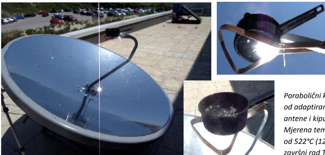
*Parabolični koncentrador  $D=1,83$  m od adaptirane telekomunikacijske antene i kipuća voda u žarištu. Mjerena temperatura čelične ploče od  $522^{\circ}\text{C}$  (12:00, 09.09.2011), završni rad Tomislav Popović, 2011.*
