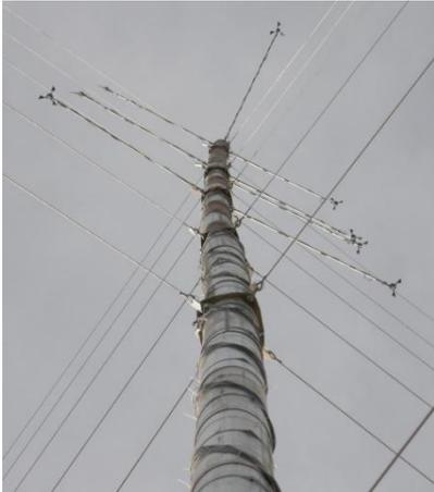
*Pogled na anemografski stup 60 m visine sa nosačima različitih senzora ostvarenog u suradnji sa Ivanom Barišićem, 2008.*
